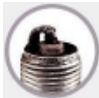
Verschmelzungen treten z.B. durch Glühzündungen (Kerze zu heiß) oder klopfende Verbrennung auf.
