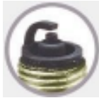
Verrußte Kerze z.B. wegen ungünstigen Einsatzbedingungen, falscher Gemischaufbereitung oder zu kaltem Wärmewert
